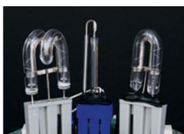
短時間に比較的大きなエネルギーをランプに投入し、瞬間的に高出力の光を出す構造のフラッシュ(flash)ランプです。連続発光ランプと比較して瞬間的に多くの電力の入力が必要であり、極めて大きな光量(エネルギー)が発散されます。このランプの封入ガスは、製造上(材料の選択)、使用上(発光電圧が低い)の利便性からキセノン(Xe)ガスを利用しています。封入しているこのガスの名前からキセノンランプと言う名前が付きまして。キセノンランプは耐振固定が可能なので耐振性も優れてます。又は可視光のスペクトラム分布が太陽光に近いだけでなく、カメラのストロボと同じ発光方式なので周りが明るい環境でも視認性が優れているのが特徴です。
