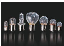
電球はフィラメント(金属の細い線)に流れる電流により発生される温度反射を利用した発光体で、フィラメントにはタングステン線をコイル型に巻いたものを使用しM、ガラス球内には不活性ガス(アルゴンなど)が注入されています。一般的にガス引入電球の特性は以下ようになります。
