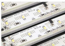
LEDは特殊半導体のPN接合部に電流を入力して発光させる発光素子として電気⇄光変換効果を極大化した GaAs、GaP などのような半導体を利用されています。一般的な半導体素子のように、過電圧や周囲温度が寿命に影響を与えますが、機械的摩耗部分が無いので、特別な耐振構造を備えていなくても重撃や振動に強く、寿命が長めになります。LEDの一般的な寿命は約 20,000~50,000 時間です。
